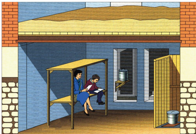
Рис. 4 — Подвал, приспособленный под укрытие
